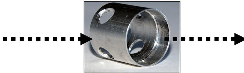
Dans des conditions de froid extrême, recouvrir les trous de la jauge de température par un ruban adhésif. Assurez-vous que la jauge d'isolement de température est réajustée pour conditions météorologiques plus chaudes. Le non-respect de cette consigne peut entraîner la combustion des interrupteurs du ventilateur- non couverts par la garantie..
