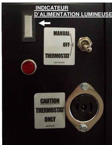
Le voyant de alimentation electrique aidera a detecter toute alimentation defectueuse fournie a l'appareil, par exemple: Problemes de mise a la terre, polarite inverse ou connexions manquantes/mauvaises.
