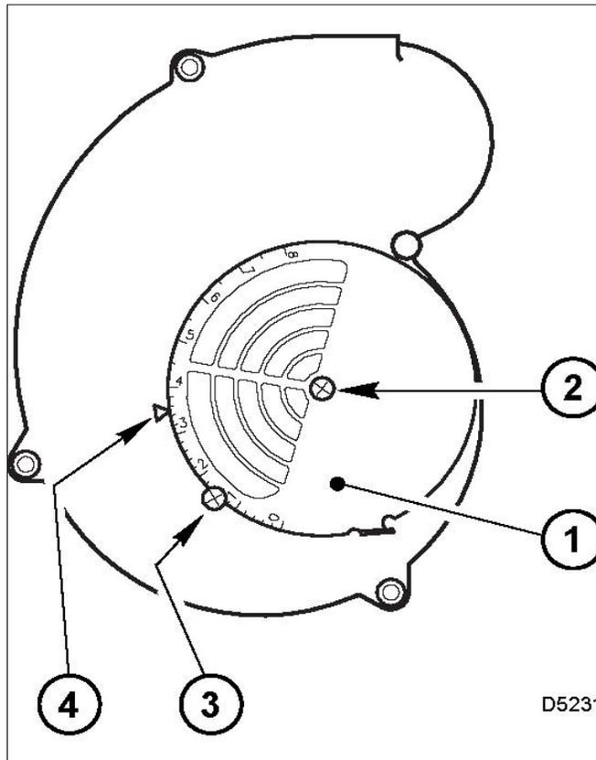
**C)** La position définitive de la plaque d'ajustement d'air sera différente pour chaque installation. Utiliser des instruments pour établir les réglages appropriés de CO<sub>2</sub> et vous assurer qu'il n'y ait aucune trace de fumée.
