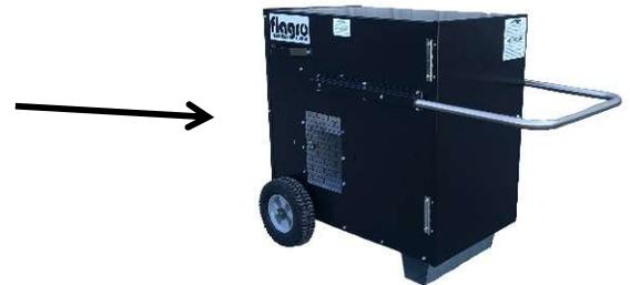
**CAUSE PROBABLE :** Si l'arrière de l'appareil est obstrué la mise à zéro manuel pourrait s'enclencher et doit être réglé manuellement avant que le ventilateur ne puisse démarrer.
